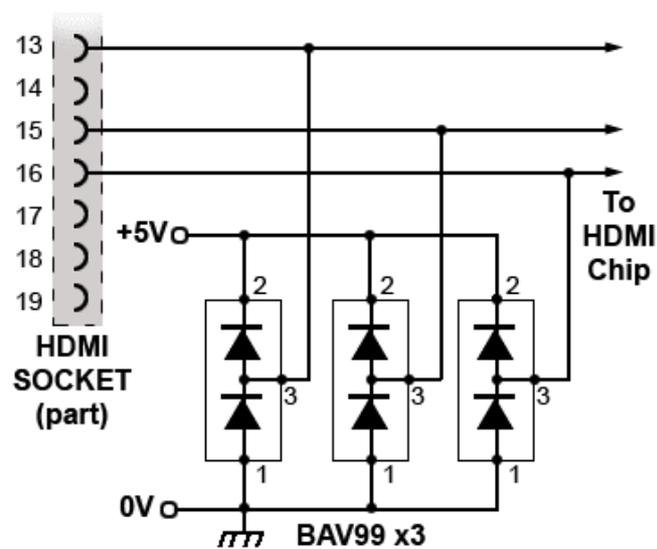
Figure 2.3.11. Protection Diodes
