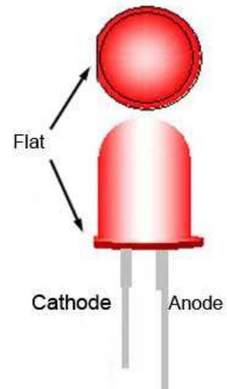
**Figure 2.5.11. LED Polarity**
