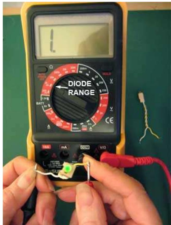
**Figure 2.5.12. Testing a LED**
