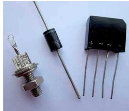
Figure 2.1.1. Silicon Rectifier Diodes
