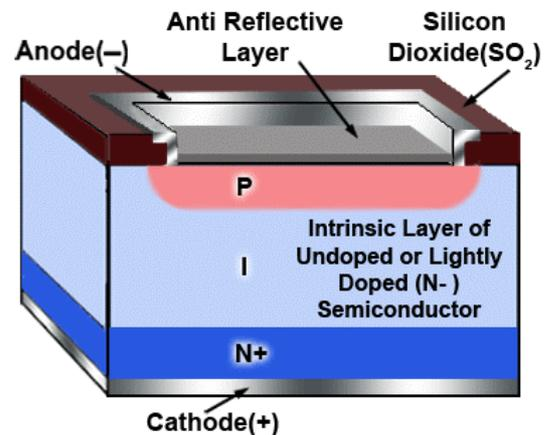
**Fig. 2.7.8 PIN Photodiode**
