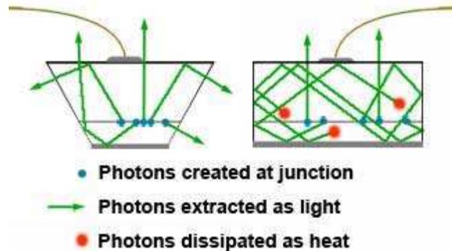
**Figure 2.5.7. Internal Reflection**
