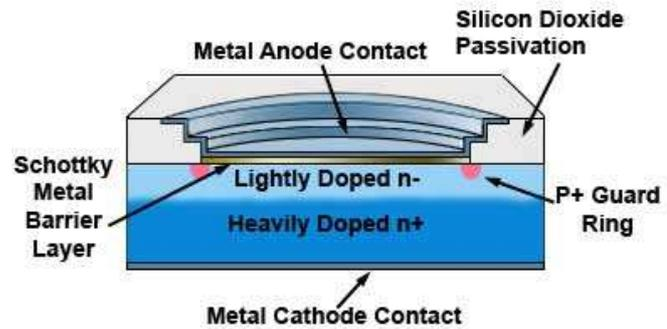
Figure 2.2.5. Schottky Rectifier Diode
