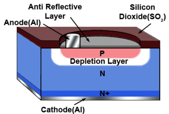
**Fig. 2.7.3 Photodiode Construction**
