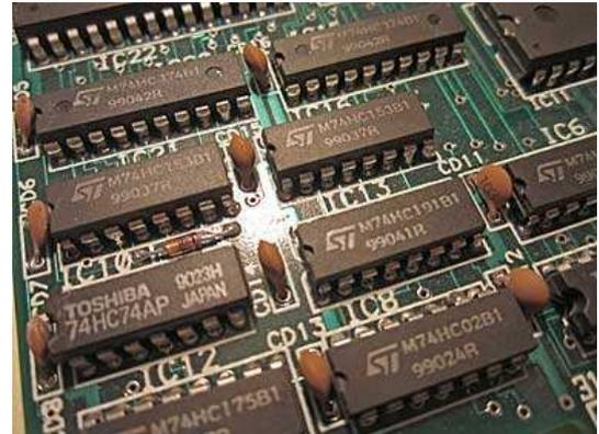
Fig. 3.3.2 Logic IC Decoupling
