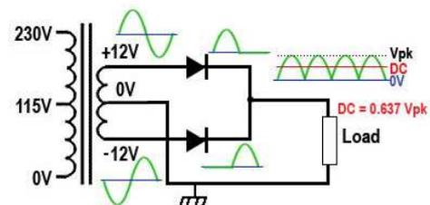
Fig. 1.1.3 Full Wave Rectification
