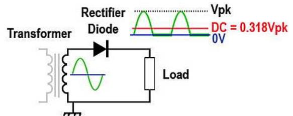
Fig. 1.1.2 Half Wave Rectification
